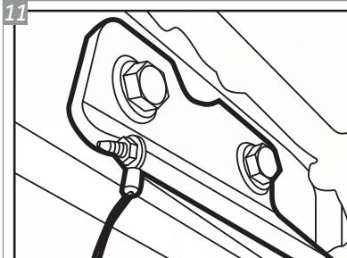
Fixar o cabo de aço presente na estrutura do veículo ao suporte do Engate de Reboque e prender ele utilizando uma Porca "E".
