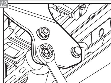
Posicione o Conjunto Estrutura "K" entre os Suportes "J" e fixe-os com Parafusos "A". (Pode se fazer necessário afrouxar os fixadores dos Suportes a fim de fazer o Conjunto "K" passa entre eles).
