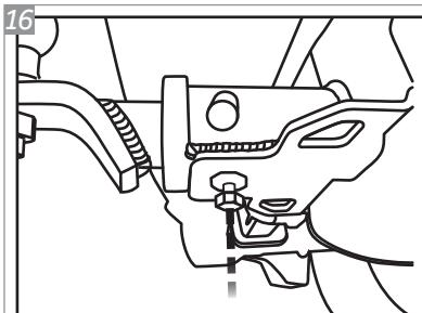
Após posicionar a ponteira K1, localize o manipulo anti-ruido, na parte inferior do engate. Aperte o mesmo com a ferramenta "M", para evitar que a trepidação do veículo, em terrenos irregulares, gere ruídos indesejados.
