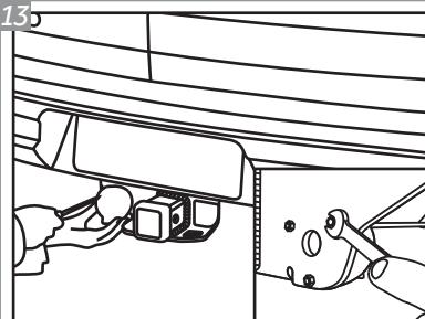
Posicione a Tomada "G" no conjunto estrutura nas furações indicadas e insira os Parafusos "B", com Porcas "D". Para fixar a tomada, utilize a chave phillips e chave 8.
