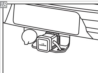
Após colocada, a tampa de proteção deverá ser fixada com o Pino Trava "I" e com o Grampo "H" afim de evitar a perda da mesma.
