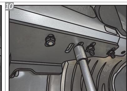
**No lado esquerdo, positione o protetor térmico e o Suporte "K" e fixando-os aos parafusos das Travas Duplas, com Arruelas "F" e Porcas "D". Repita os passos 7-10 no lado direito do veículo.**
