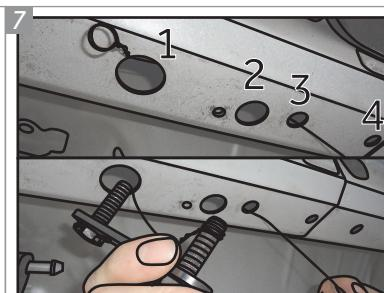
**Introduza o arame no furo três do chassi, fazendo com que sua outra extremidade saia pelo furo um. Enrole uma de suas extremidades em um parafuso da Trava Dupla "G".**
