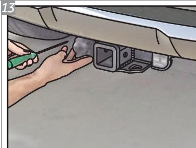
Posicione a Tomada "H" no conjunto estrutura nas furações indicadas e insira os Parafusos "B".
