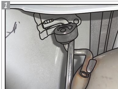
**Com uma chave de fenda, solte os dois coxins que prendem o escapamento.**
